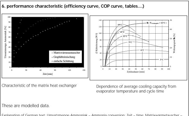
Explanation of German text: Umsatzmenge Ammoniak – Ammonia conversion; Zeit – time; Matrixwärmetauscher – matrix heat exchanger; Graphitbeimischung – with graphite; Einfache Schüttung – granular bulk material; Kälteleistung – cooling capacity; Zyklusdauer – cycle time; Wirkungsgrad – efficiency; T\_verdampfer – evaporator temperature.
